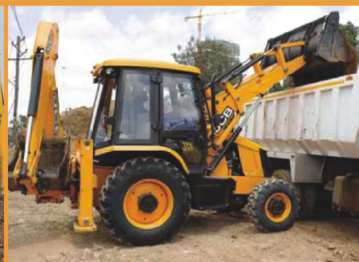
平行鏟斗臂設計提供最佳的傾斗高度、傾斗距離、負載保持及快速卸貨功能。
