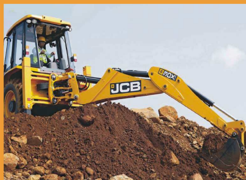
挖土臂狹小化設計，提供操作者最寬廣的視線。
